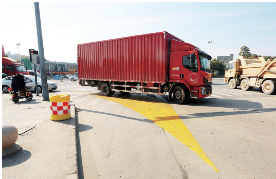
用黄色油漆标示的“内轮差”警示线。深圳侨报通讯员 邱雯 摄
